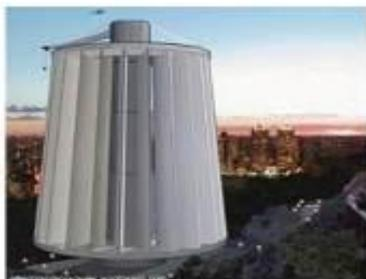
Foi apresentada recentemente, na China, a turbina MagLev, que utiliza levitação magnética. As pás verticais desta turbina de vento são suspensas no ar acima da base do equipamento, sem contacto com outras partes mecânicas, o que elimina o atrito, aumentando exponencialmente o seu rendimento.
